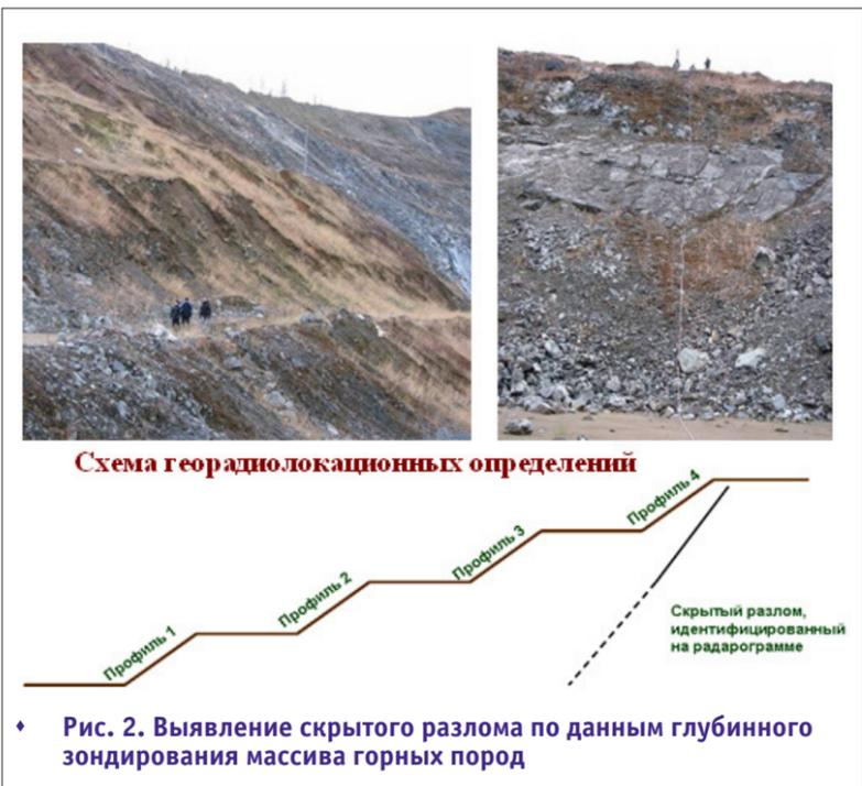
♦ Рис. 2. Выявление скрытого разлома по данным глубинного зондирования массива горных пород
