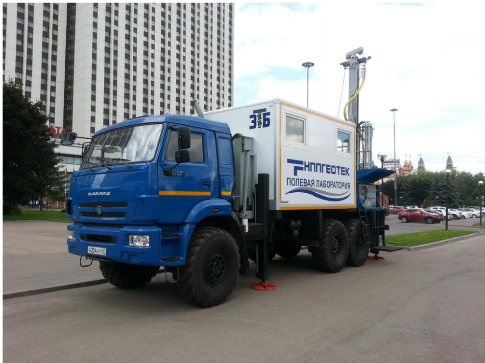
♦ **Рис. 4** Мобильный комплекс для производства полевых и лабораторных испытаний. Разработка НПП «Геотек» (Пенза) и «Завода буровой техники» (Санкт-Петербург)
