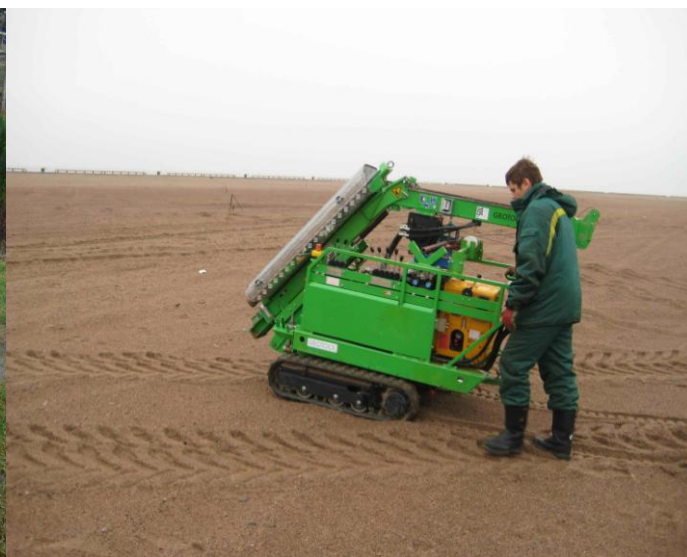
Самоходная установка динамического зондирования ( производство компании «Geotool», Германия) (глубина зондирования до 30 м)
