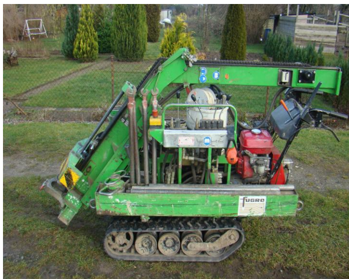
Самоходная установка динамического зондирования ( производство компании «Фугро» (глубина зондирования до 20 м)
