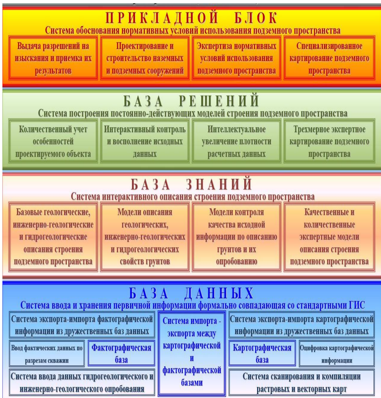
Блок-схема технологии трёхмерного картирования подземного пространства (по Е. А. Ломакину, 2011)
